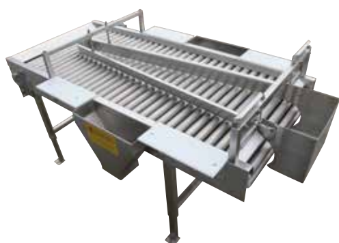
Rolkowy stół selekcyjny z lejami selekcyjnymi, listwami rozdzielczymi i półkami do rozcinania produktów
